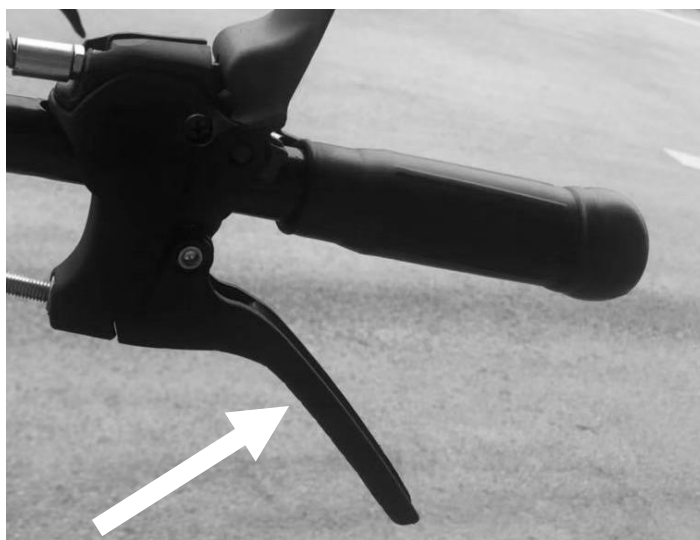
Рычаг разблокировки левого колеса расположен на левой ручке руля
