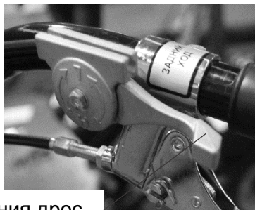
Рис.12 ручка управления дроссельной заслонкой
